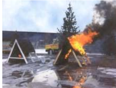
Comble à la paroi intérieure revêtu du latex SafeCoat et comble non revêtu soumis à des conditions d'incendie identiques.
